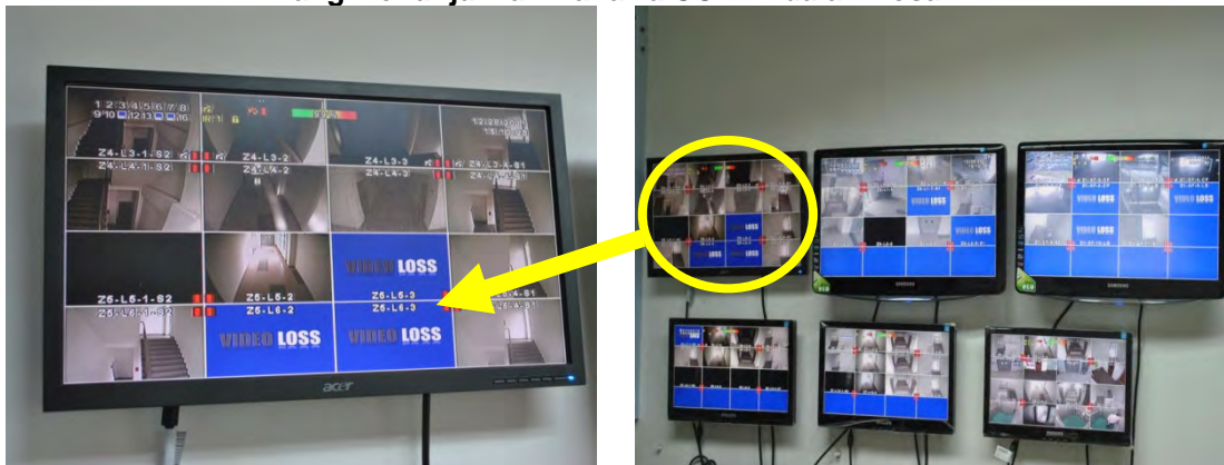
Gambar 4.17 Skrin Kawalan CCTV Memaparkan Video Loss Yang Menunjukkan Bahawa CCTV Adalah Rosak
